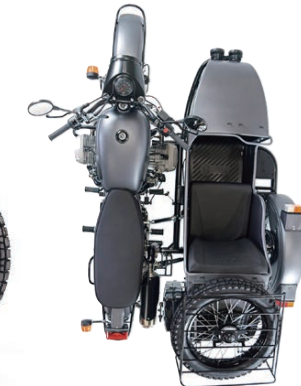
●全幅は162cm。変速機は前進4段、後進1段。サイドカーホイールも駆動する
