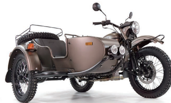
●空冷の水平対向2気筒エンジンは749cm 3 、最高出力は41馬力、最大トルクは5.81kgf・m
